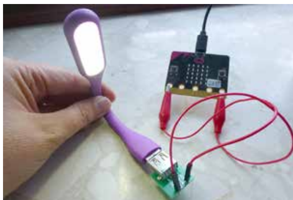
Rysunek 1. Układ – lampka podłączona do mikro:bita.
